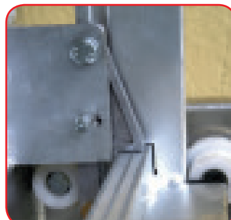
Gancio automatico sostegno piattaforma
