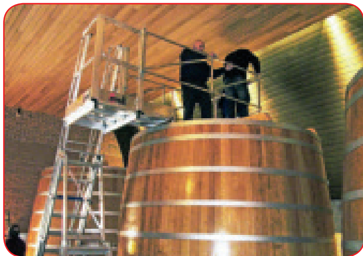
Versione con sbarco e protezione laterali
